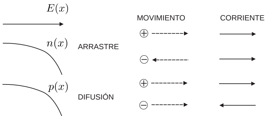
FIGURA 7.12: Sentido de las corrientes de difusión y de arrastre para electrones y huecos.
