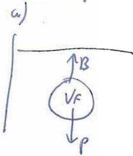
un volumen  $V_f$  de fluido restó sometido a dos fuerzas, el peso  $P_f = \rho_f g V_f$  y el empuje  $B$ , por lo tanto  $B = P_f$  en módulo
