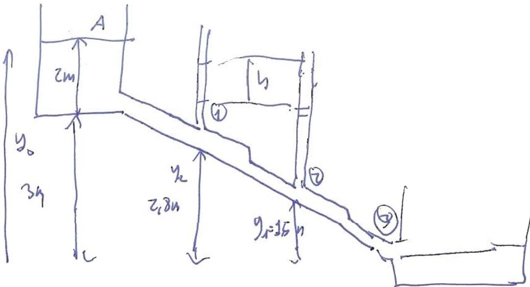
Per el teorema de Torricelli:  $v_3 = \sqrt{2gy_0} = \sqrt{2 \times 10 \times 5} \Rightarrow v_3 = 10 \text{ m/s}$
