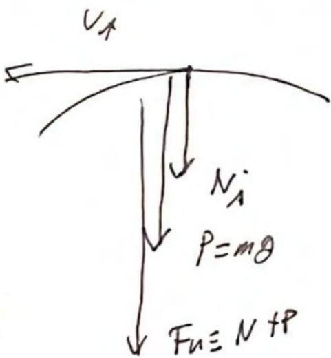
En A, la velocidad es horizontal, luego tanto  $N_A$  como  $P$  son perpendiculares a  $\vec{v}_A$  y en su tanto la fuerza normal. Como realiza un círculo, su radio de curvatura es  $R$ , el radio del círculo.
