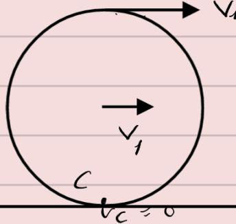
$\gamma_2 = \omega_1 CR = 2V_1$ ;  $\omega_1 = \frac{V_1}{R}$ , Ademas para el disco I respecto del eje es  $I_c = \frac{1}{2}MR^2$ . Sustituyendo en (1) con  $m_1=M$  y  $m_2=m$ .
