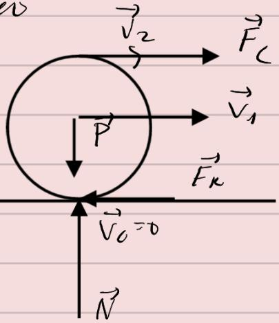
$\vec{N}$  y  $\vec{F}_k$  aplicados en C no realizan trabajo, pues  $V_C = 0$ .  $\vec{P}$  tampoco,  $dW_P = \vec{P} \cdot d\vec{l} = \vec{P} \cdot \vec{V}_1 dt = 0$ , ya que  $\vec{P} \perp \vec{V}_1$ . Luego solamente  $\vec{F}_C$  realiza trabajo y  $W_T = W_C \Rightarrow$
