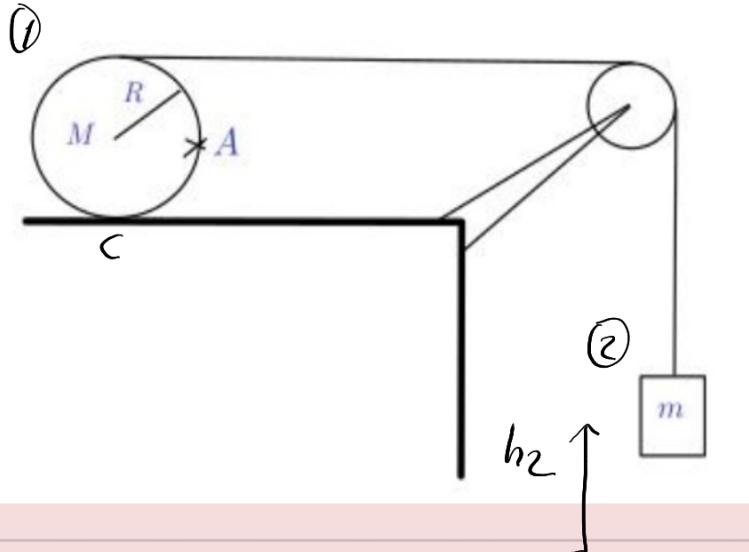
En la rodadura el punto de contacto C tiene velocidad instantánea nula para lo que el trabajo de rozamiento es nulo  $dW_R = \vec{F}_R \cdot d\vec{r} = \vec{F}_R \cdot \vec{v}_C dt = 0$ . En la polea tampoco hay rozamiento, por lo que se cumple la energía mecánica.
