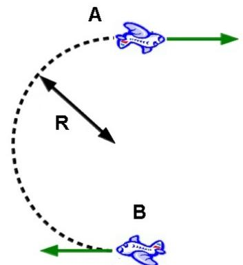
**6. Piloto acrobático.** Un piloto de  $80 \text{ kg}$  ejecuta con una avioneta un rizo de  $125 \text{ m}$  de radio. Determinar la velocidad de la avioneta en los puntos A y B sabiendo que en A el piloto experimenta la sensación de no tener peso, y en el punto B de tener un peso de  $280 \text{ kg}$ .
