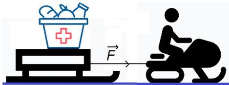
**10. Trineo y caja.** Sobre un trineo de 50 kg se transporta una caja de suministros de 100 kg. Los coeficientes de rozamiento entre el trineo y la caja son  $\mu_e=0.3$  y  $\mu_d=0.2$ . El rozamiento entre el trineo y la nieve dura es despreciable y una motonieve aplica una fuerza horizontal de módulo  $F$  sobre el trineo como se indica en la figura.
