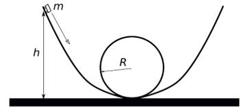
**15. Montaña rusa.** Una vagoneta de masa  $m$  desliza sobre un raíl sin rozamiento en un rizo vertical de una montaña rusa, como se indica en la figura. La vagoneta se mueve sin perder en ningún momento el contacto con el raíl. Si en el instante inicial la vagoneta está en reposo a una altura  $h$ , determine el valor mínimo de esa altura  $h$  (en función de  $m$ ,  $R$  y la gravedad  $g$ ) para que consiga superar el rizo.
