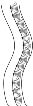
*cada punto de un frente de ondas primario se comporta como un foco de ondas esféricas elementales secundarias que avanzan con una velocidad y frecuencia igual a la onda primaria. La posición del frente de ondas primario al cabo de un cierto tiempo es la envolvente de dichas ondas elementales.*
