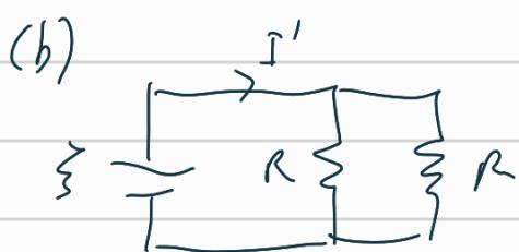
Calculando la resistencia equivalente a  $R$  en paralelo con  $R$ :  $\frac{1}{R'} = \frac{1}{R} + \frac{1}{R} = \frac{2}{R} \Rightarrow R' = \frac{R}{2}$
