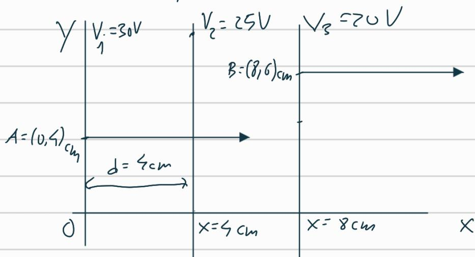
(b) No falta el módulo  $E$ , sabemos que en un campo uniforme  $|ΔV| = Ed$ , siendo d el desplazamiento en la dirección del campo. Sabemos que  $d = 4 \text{ cm}$  para  $|ΔV| = 30 - 25 = 5 \text{ V}$ , luego  $E = \frac{|ΔV|}{d} = \frac{5 \text{ V}}{0.04 \text{ m}} \Rightarrow$
