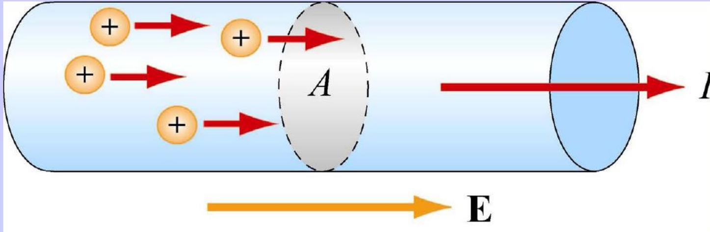
Notar que cuando hay intensidad de corriente, el conductor ya no es un volumen equipotencial (y  $E_{\text{interior}} \neq 0$ )!
