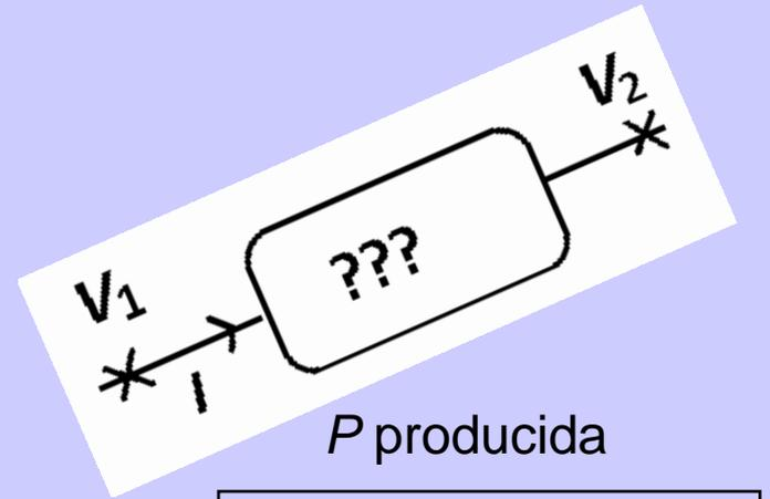
$$P = I(V_2 - V_1)$$
