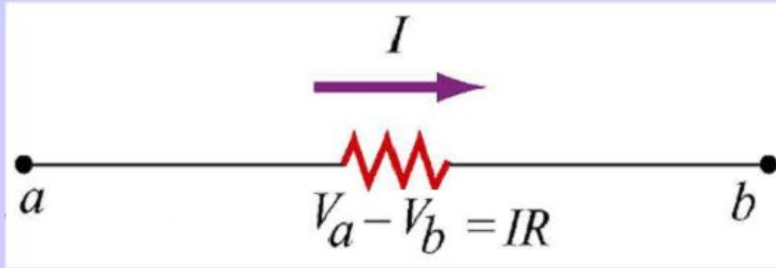
Al moverse a lo largo de una resistencia en la dirección de la intensidad, el potencial **disminuye**
