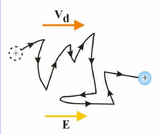
La velocidad de arrastre o deriva es la velocidad producida por el campo eléctrico aplicado en presencia de colisiones.
