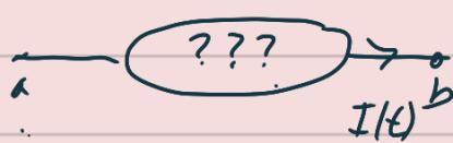
$$\begin{aligned} V(t) &= V_a - V_b \quad \text{"caida" de potencial} \\ P(t) &= V(t) I(t) \quad \begin{cases} \text{Potencia instantánea} \\ \text{consumida} \end{cases} \end{aligned}$$
