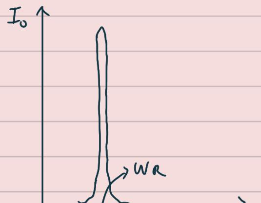
Entonces para  $R$  pequeña,  $I_0$  es distinta de cero en un pequeño intervalo de frecuencias en torno a  $\omega_R$ . Tenemos en sintonización, como por ejemplo, un teléfono móvil. Para que una conversación no ojunte con la otra, cada teléfono usa una frecuencia.
