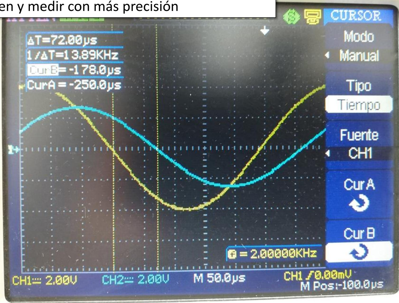
Disminuya aún más la escala de tiempos para ampliar la imagen y medir con más precisión
