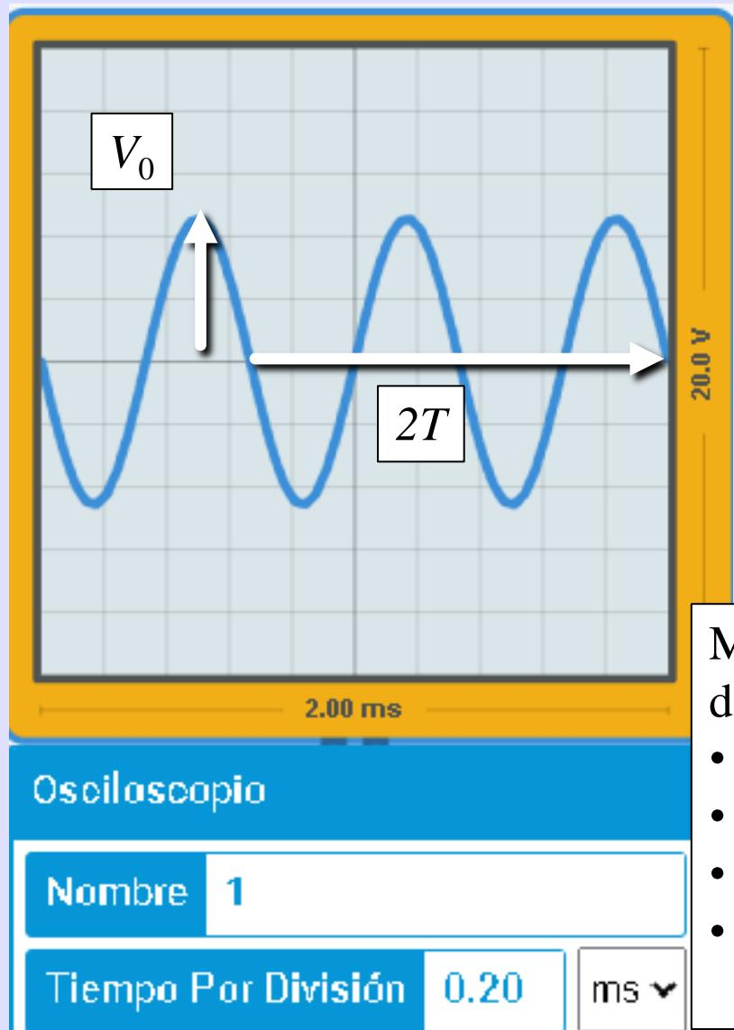
Medida de la amplitud  $V_0$
