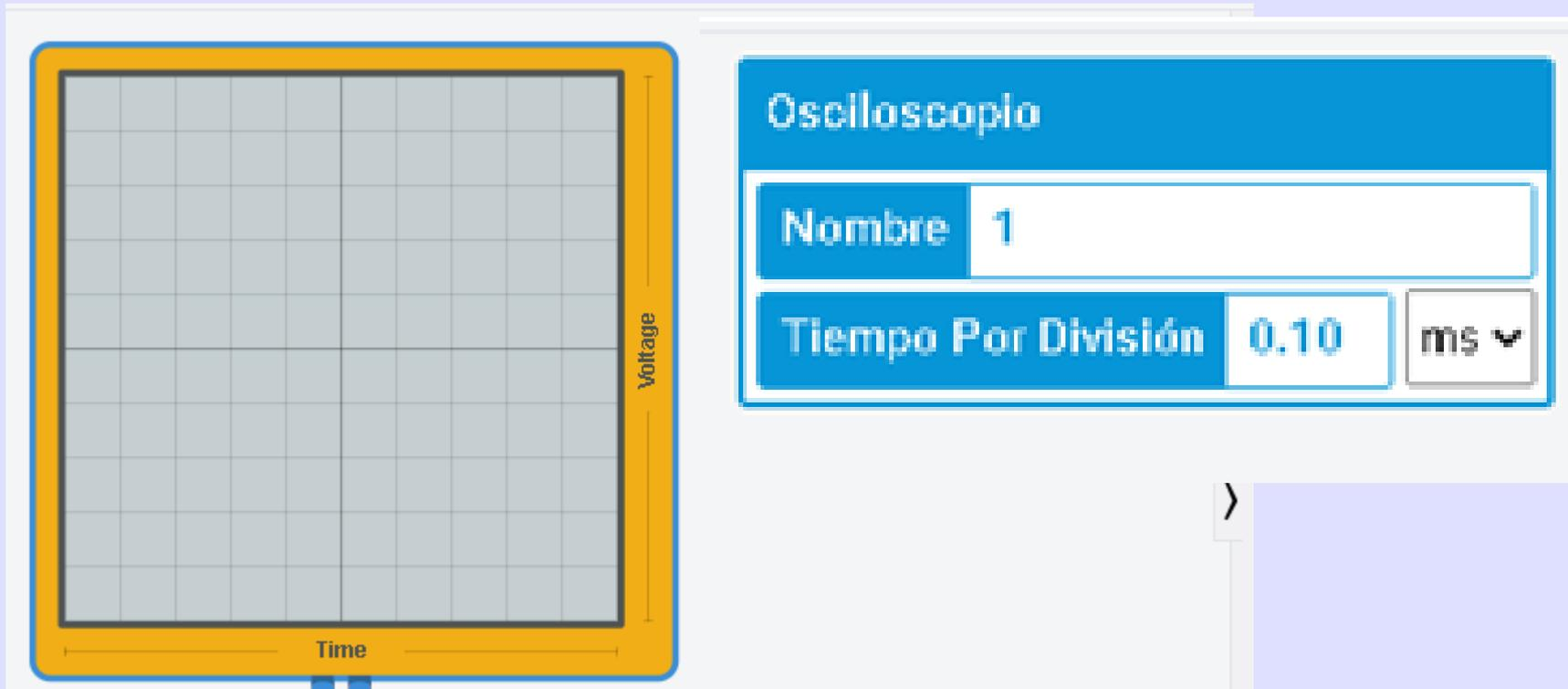
Medida con el osciloscopio de Tinkercad:  $\text{Div}=\text{Pantalla}/10$  y estimamos la incertidumbre en  $\text{Div}/5=0.2*\text{Div}$
