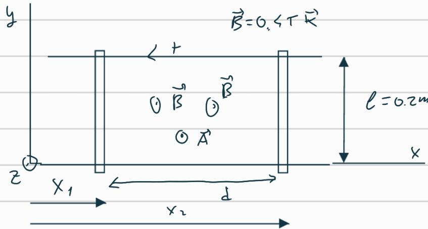
Elegir un eje coordenado como se ve en el dibujo, de forma que  $x_2$  y  $x_1$  sea los coordenadas  $x$  de las barras.
