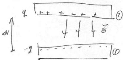
Suponemos un condensador a modo de caja con carga  $q$  (arriba) y  $-q$  (abajo).
