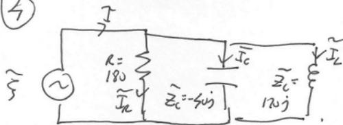
Esquema de impedancias, amplitud y fase
