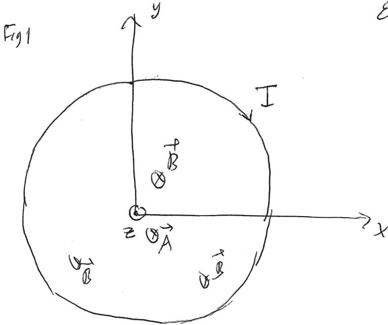
El campo magnético producido por un solenoide cilíndrico en su interior es uniforme, paralelo al eje del solenoide, con módulo  $B = \mu_0 n I$  ( $n = \frac{N}{l}$ ) y con el sentido relacionado con I por la regla de Maxwell. ( $\vec{B}$  tiene el sentido de avance de un tornillo que gira con la intensidad)
