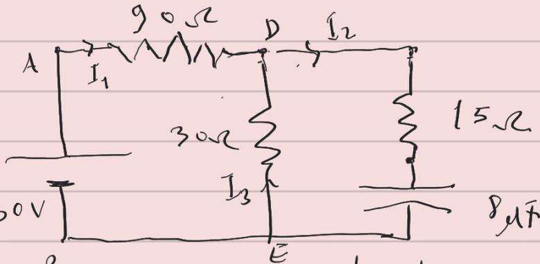
Nombreamos las intensidades según se indica en la figura. Podríamos por  $V_A > V_B$ ,  $I_1$  debe ir de A a B como se indica e igualmente las otras dos intensidades.
