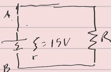
$$V_R = V_{AB} = 14,4 \text{ V}, \quad \text{Potencia consumida en } R: P_R = I^2 R$$
