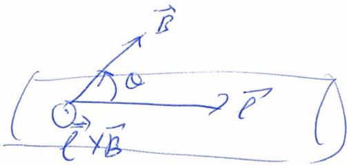
$F_{in} = I |l \times B|$ , pero  $\vec{l} \times \vec{B}$  es hacia el exterior, perpendicular al plano de  $\vec{l}$  y  $\vec{B}$ . El sentido será dado por la regla de Maxwell o mano de izquierda que gira de  $\vec{l}$  a  $\vec{B}$  por el camino más corto.
