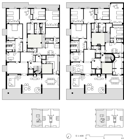
Figura 7. Planta Tipo inmueble n° 5 de la Avenida de la República Argentina. Izquierda, Planta Versión Inicial - Derecha, Planta Versión Final. Planimetría de los autores
