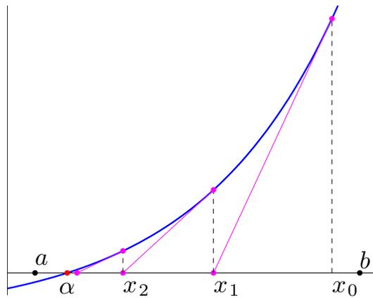
Figura 8.6: Interpretación geométrica del método de Newton.
