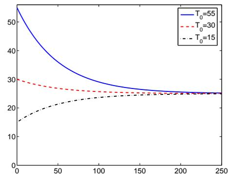
Figura 9.3: Representación gráfica de la función  $T = M + (T_0 - M)e^{-kt}$ , solución del problema de valor inicial (9.8), para  $M = 25$ ,  $k = 0.02$  y varios valores del dato inicial  $T_0$ .
