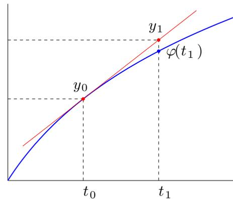
Entonces, si la distancia  $t_1 - t_0$  es pequeña, se puede “asimilar” la curva  $y = \varphi(t)$  con su tangente en el punto  $(t_0, y_0)$  y por lo tanto aproximar el valor  $y(t_1)$  por el valor que tome, en  $t_1$ , dicha tangente, que es:
