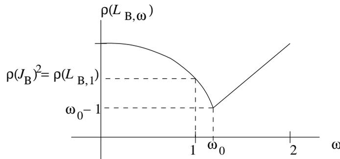
con  $\omega_0 = \frac{2}{1 + \sqrt{1 - \rho(J_B)^2}}$ . De modo que el método es óptimo para  $\omega_0$  siendo  $\rho(\mathcal{L}_{B,\omega_0}) = \omega_0 - 1$ .
