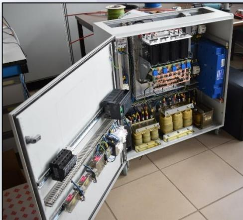
Convertidor y ultracondensador para el generador.
