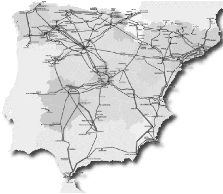
Figura 1.2. Red española de 400 kV y 220 kV en el año 2000 (fuente [8]).
